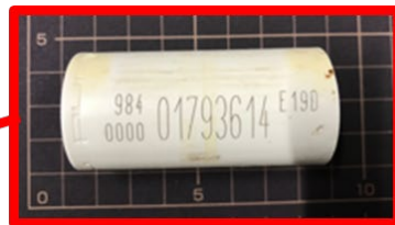
RFIDタグ 15桁の数字 直径3cm、高さ6cmの円柱形
