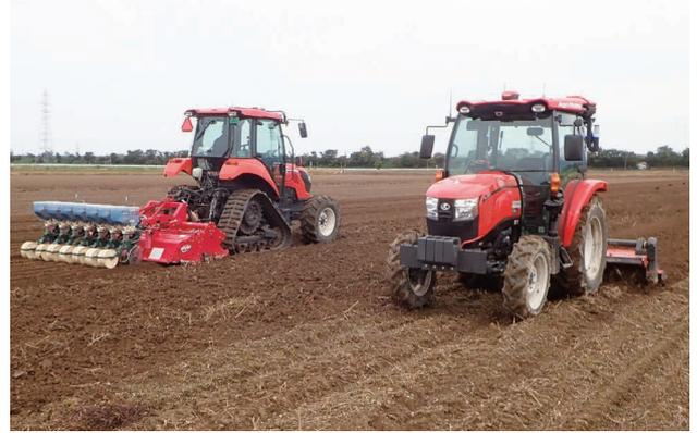
▲ 自動運転トラクタと有人トラクタとの同時作業
