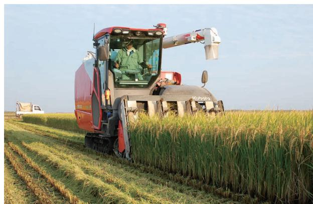
▲ 収量コンバインではほ場1枚ずつ収量を計測
