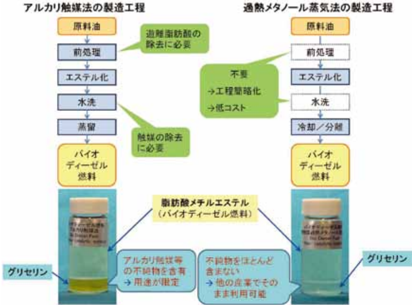
図5 アルカリ触媒法と過熱メタノール蒸気法の工程の比較
