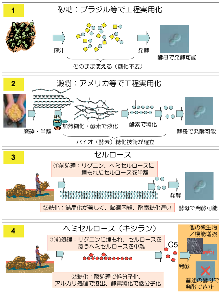
図1 草本原料中の主要糖質からエタノールへの変換プロセスの概要
