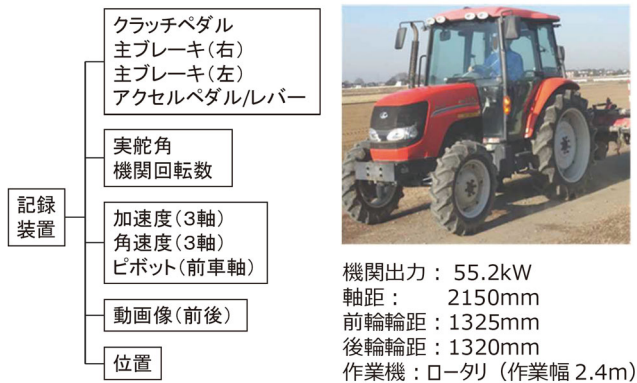
図 1-5 試作した計測装置の記録項目と供試トラクタ
