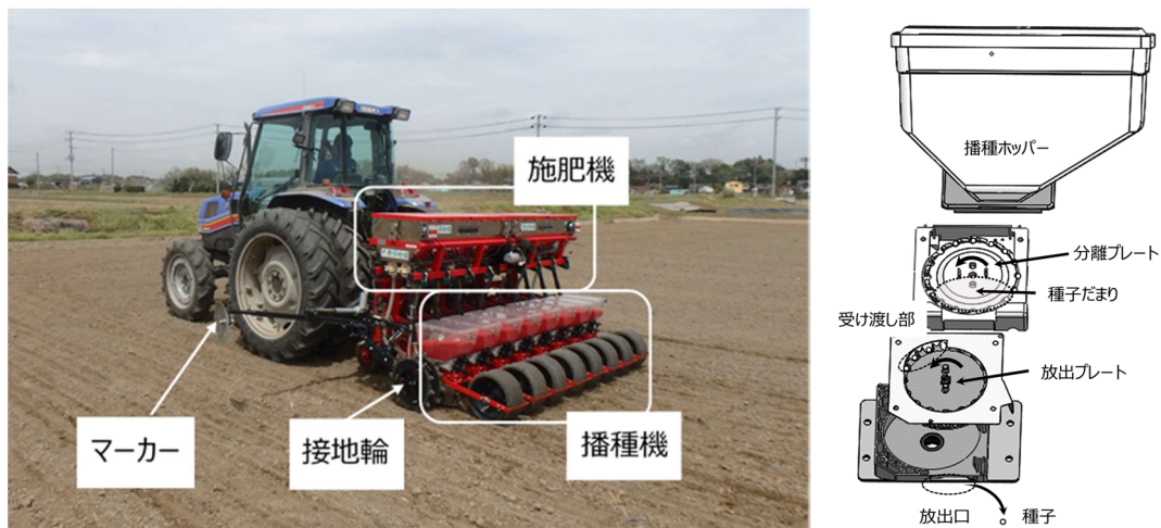
図 1-1 高速高精度汎用播種機の外観と種子繰出装置の構造
