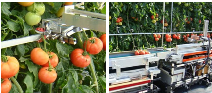
図2 トマト低段栽培用の房採り自動収穫システム(野菜茶業研究所)
