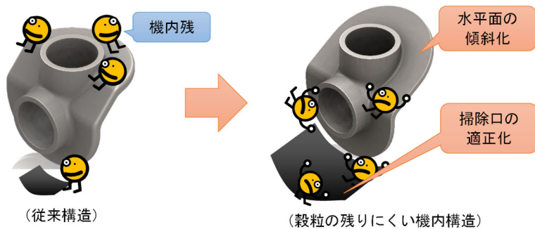
図 5-6 穀粒の残りにくい機内構造のイメージ
