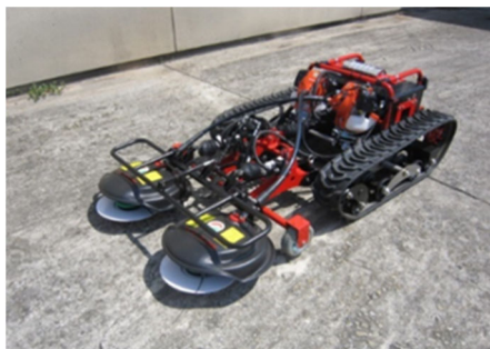
図 1-4 試作した除草ロボットの外観
