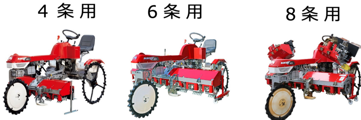
図 4-2 開発した 3 輪乗用管理機にミッドマウント搭載する高能率水田除草装置
