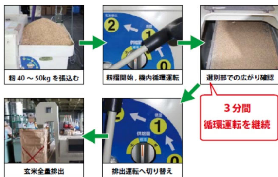
図 6-4 とも洗いの作業手順
