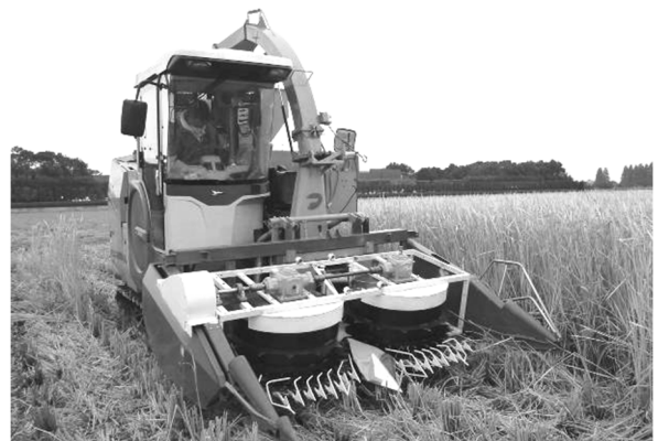
図 1-1 汎用型飼料収穫機に装着した株元切断・搬送機構 (平 24)
