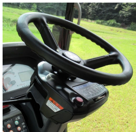
電動モータ内蔵型の操舵装置
