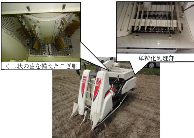
図 5-4 簡素化・省エネルギー型コンバイン
