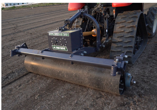
図 1-1 高速振動鎮圧機による鎮圧作業
