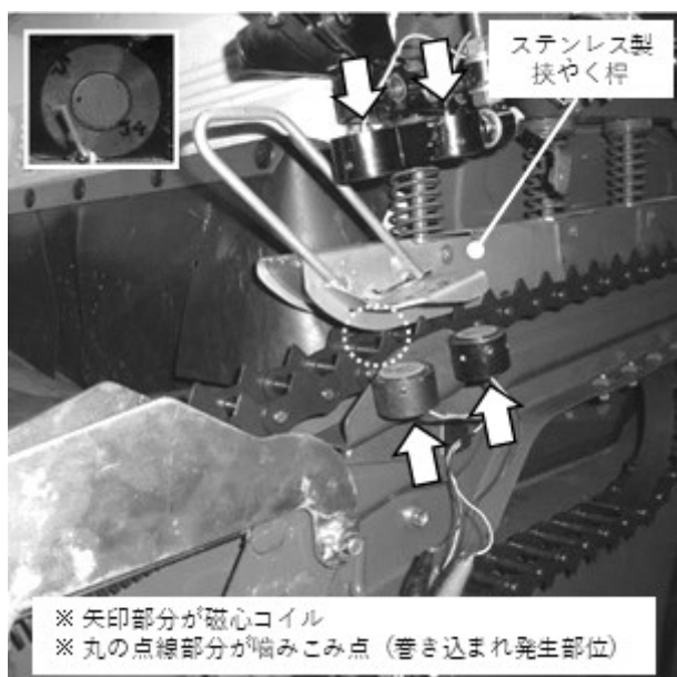
自脱コンバインの手こぎ部に設けた磁心コイル(平 25)
