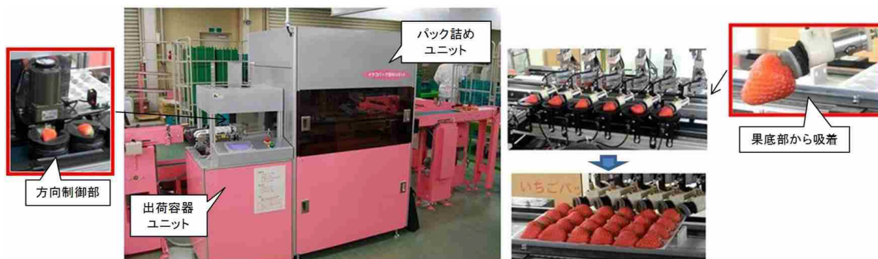
図 2-5 イチゴパック詰めロボット試作 2 号機の外観
