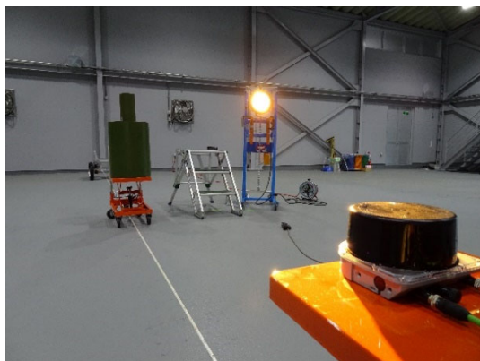
図 2-1 障害物センサ室内試験
