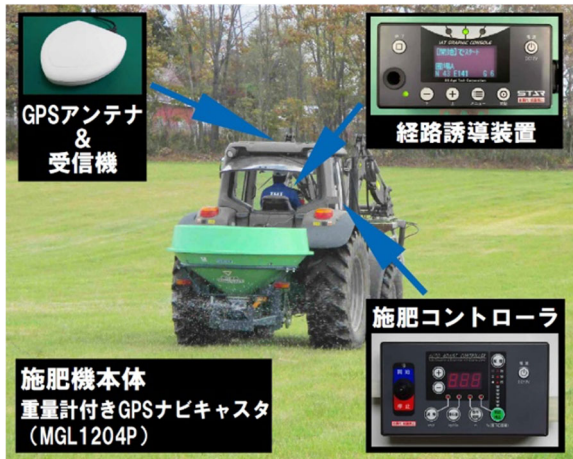
図 1-1 開発した高精度可変施肥機(市販機)の概要
