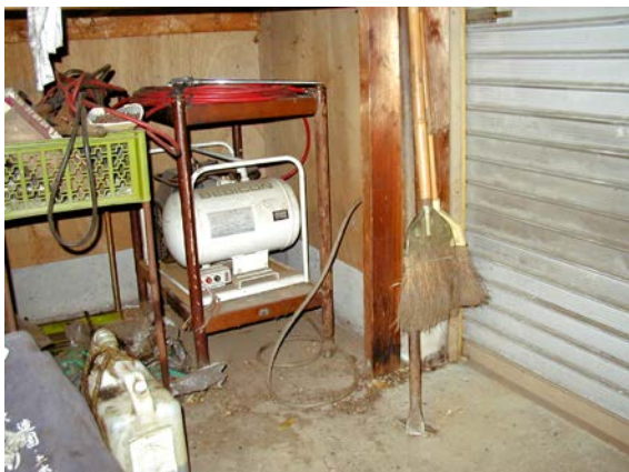
作目：共通 作業：圃場・施設管理 目的：重量物負担軽減 方法：コンプレッサをキャスタ付きキッチンワゴンに載せて、収納、運搬。
