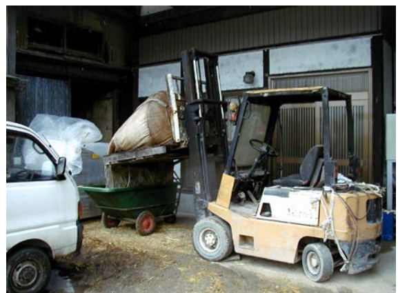
作目：畜産 作業：家畜管理、運搬 目的：重量物負担軽減、作業姿勢改善 方法：フレコンをフォークリフトで持ち上げ、飼料を下に落としながら、運搬台車へ移し替える。パレットが滑り落ちないように注意が必要。
