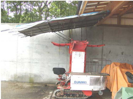
作目：タバコ 作業：収穫 目的：温度調節、明るさ調節 方法：収穫作業機へ日よけを装備。
