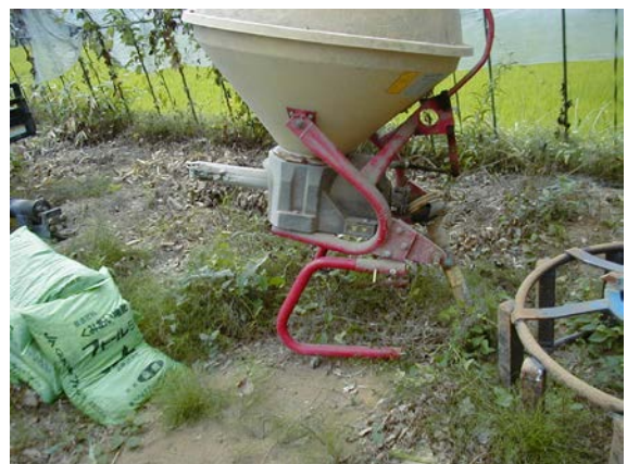
作目：共通 作業：機械使用・管理 目的：重量物負担軽減 方法：作業機のスタンドにキャストを取付け。
