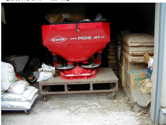
作目：共通 作業：機械使用・管理 目的：重量物負担軽減 方法：作業機をキャスト付き台に載せて保管、運搬。
