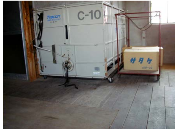
作目：共通 作業：機械使用・管理 目的：重量物負担軽減 方法：粗運搬用コンテナをキャスト付き台に載せて、保管、運搬。
