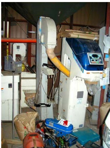
作目：水稻、穀物 作業：選別・調製、運搬 目的：重量物負担軽減 方法：糶摺り機と計量機のための受け継ぎ用に、バケットエレベータを製作。
