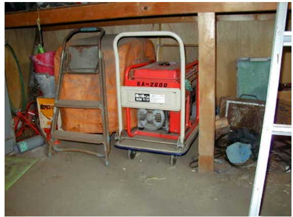
作目：共通 作業：圃場・施設管理 目的：重量物負担軽減 方法：発電機を運搬台車に載せて、収納、運搬。
