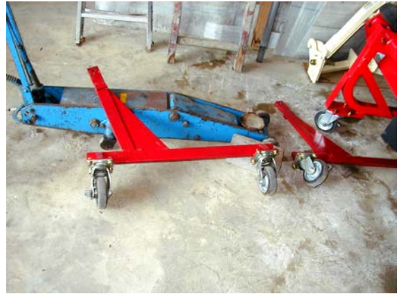
作目：共通 作業：機械使用・管理 目的：重量物負担軽減 方法：ロータリ用のスタンド（キャスト付き）を製作。
