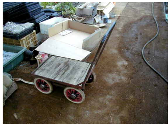
作目： 野菜 作業： 収穫、運搬 目的： 重量物負担軽減 方法： 運搬台車を使用。
