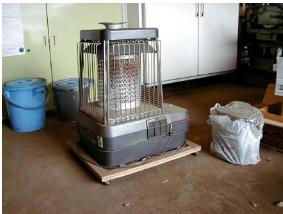
作目：共通 作業：圃場・施設管理 目的：重量物負担軽減 方法：ストーブをキャスタ付き台に載せて保管、運搬。
