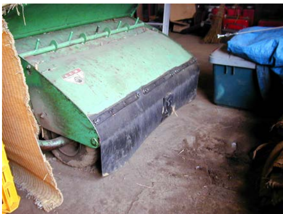
作目： 共通 作業： 栽培管理、防除 目的： 作業安全 方法： 飛散物を少なくするために、フレールモアの刈刃カバーへゴムマットを貼り付け延長。
