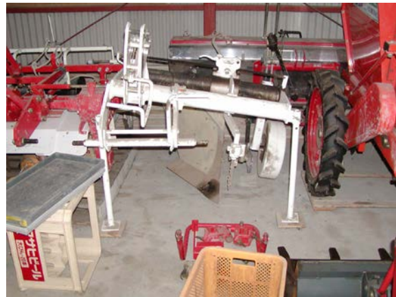
作目：共通 作業：機械使用・管理 目的：重量物負担軽減 方法：移動しやすいように作業機のスタンドの下へキャスト付き台を入れた。
