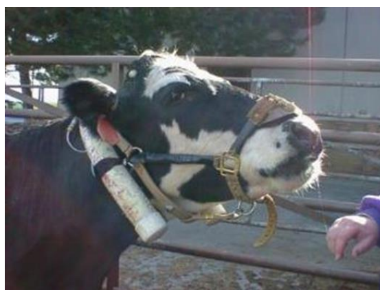
写真 1-2 SF 6 法 採取装置を装着した試験牛。
