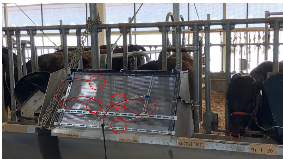
写真 3-2 飼槽蓋にガス吸引口を設置した事例 丸印はガス吸引口の位置を示す。
