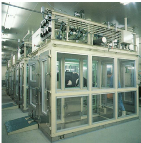
写真 1-1 間接式開放型呼吸試験チャンバー (農研機構畜産研究部門 (つくば))
