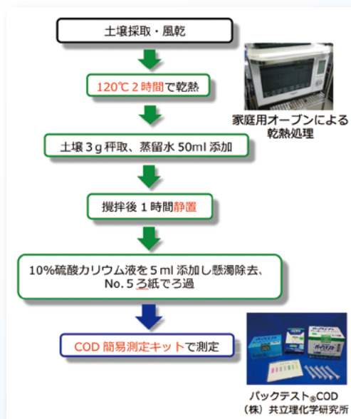
図2 普及指導機関などを対象とした可給態窒素の簡易判定法
