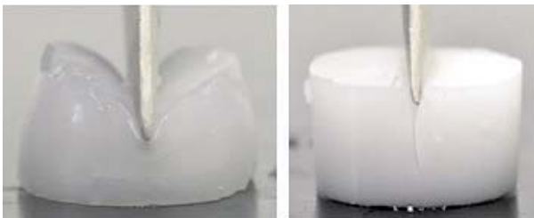
「こなみずき」でん粉ゲル（左）は、冷蔵4日後でも弾力性があるが、従来のサツマイモでん粉ゲル（右）は、弾力性がなくなり、ひび割れてしまいます。
