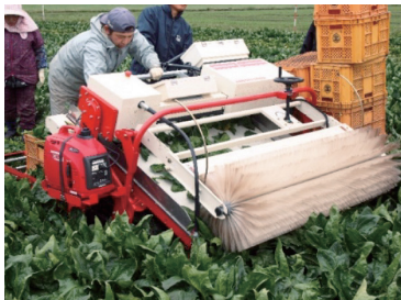
写真1 歩行型加工用野菜収穫機 (NMSH-1300 (株)ニシザワ)
