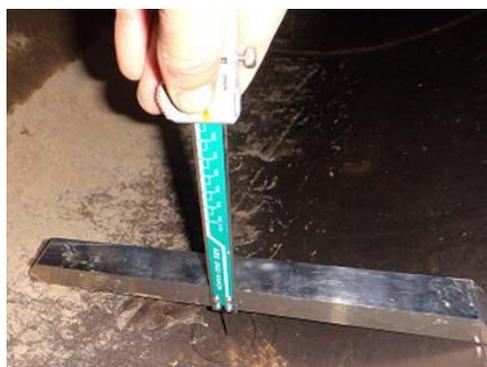
図 2 - 2 FRPM 管内部でのひずみ測定の様子
