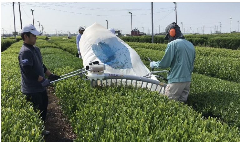
写真2 可搬型摘採機でお茶を収穫する様子
