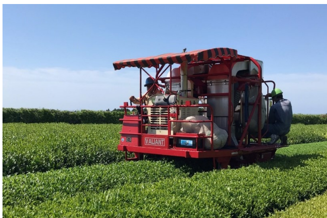
写真3 乗用型摘採機でお茶を収穫する様子
