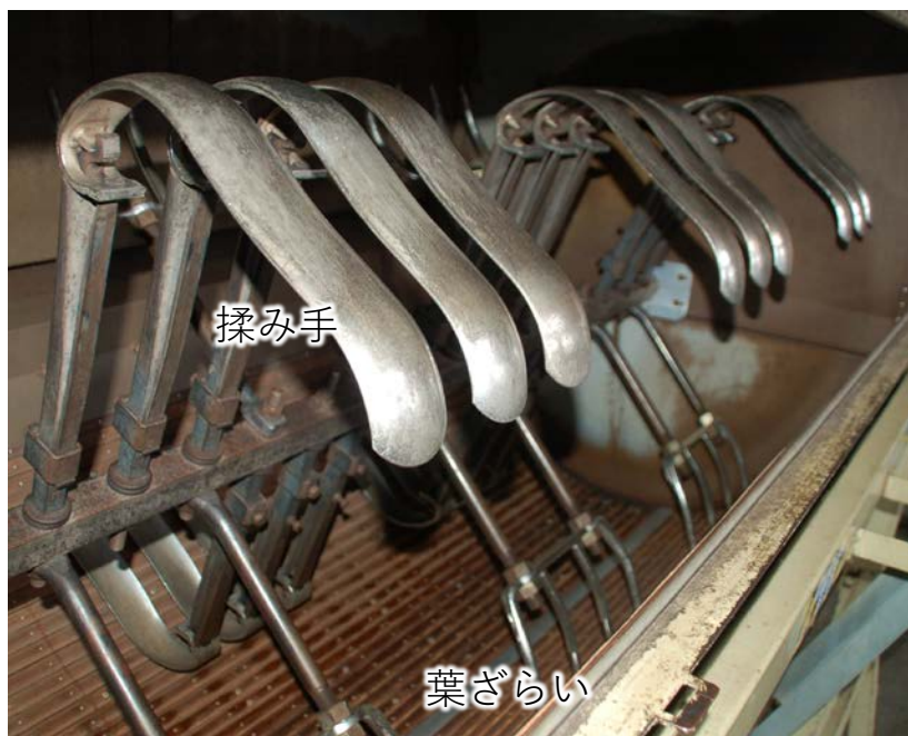
【写真2】 「粗揉機（そじゅうき）」の内部 フォークのような「葉ざらい」とへらのような「揉み手」が働いています。
