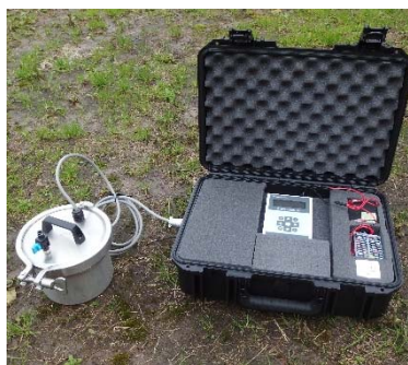
写真1 ガス拡散係数測定装置 本体は右。写真のものはログ が取れる仕様。
