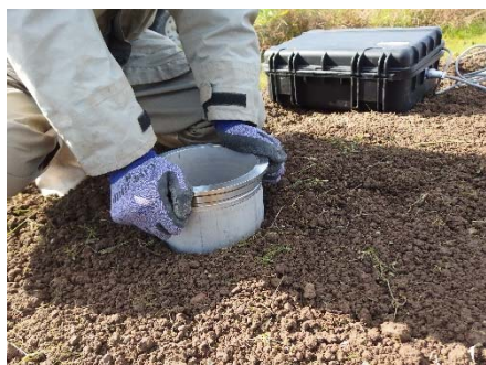
写真4 円筒の埋め込み
