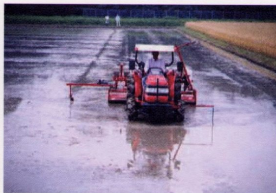
写真4：長辺方向に播種する。マーカの跡がつかない場合は水量が多すぎる。 注) 電動式マーカを使用。稲麦兼用型。
