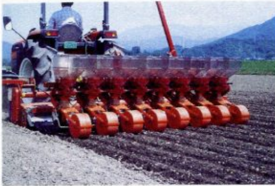
写真1. ショットガン点播機の播種ロールを交換した播種機で条間30cmの多条播
