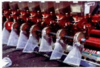
写真3. 肥料の繰り出し量を調整する
