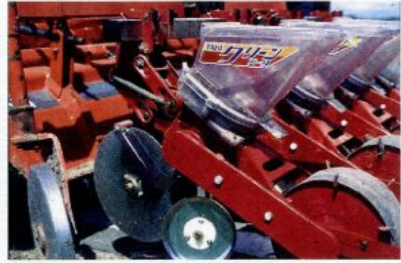
写真2. 慣行播種機で条間40cmに設定
