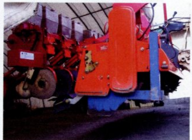
図6 作溝装置(側面図)
