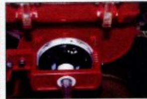
写真3. 肥料の繰り出し量を調整する
