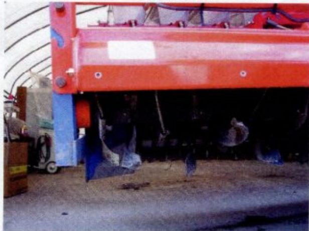
図5 作溝装置(正面図)
