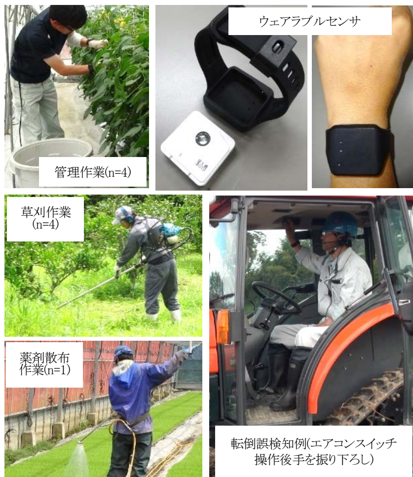
図3 センサ装着試験および転倒誤検知例
