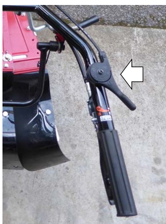
図6 固定式スロットルレバー
