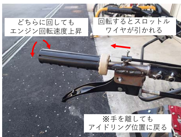
図7 エンジン回転速度が調整可能な ハンドルグリップ
