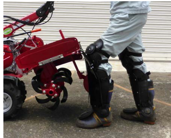
図2 作業者の保護(野球用レガース)
