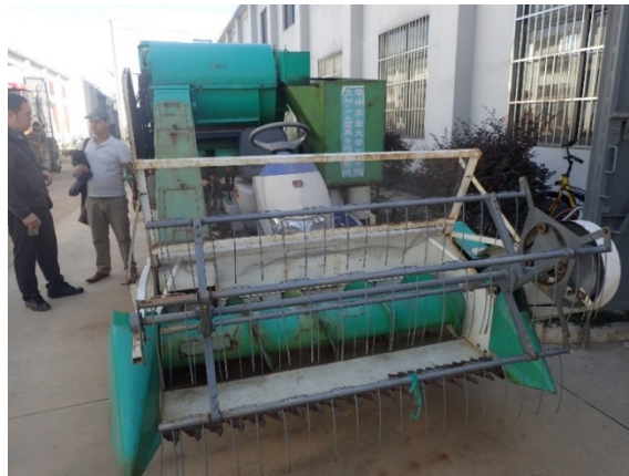
図8 田植機にコンバイン機能を持たせた開発機
