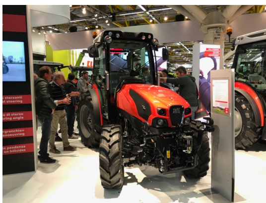
図9 100PS 超えでも後輪操舵可能なトラクタ 全長 3.8m、車幅 1.6m、車重は 3.6t
