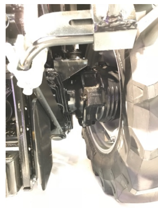
図10 後車軸に組み込まれた等速ジョイント
