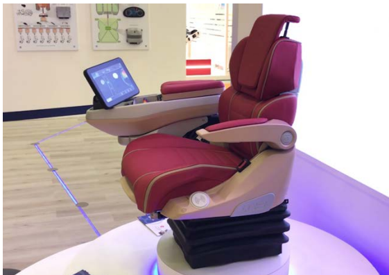
図5 ISOBUS 汎用端末から制御できる COBO 社の電動椅子
