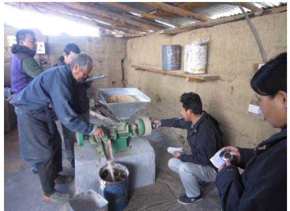
図6 精米機作業精度試験
