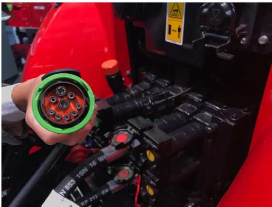
図 3 トラクタとカルチベータは ISOBUS コネクタと油圧ホース類で接続される
