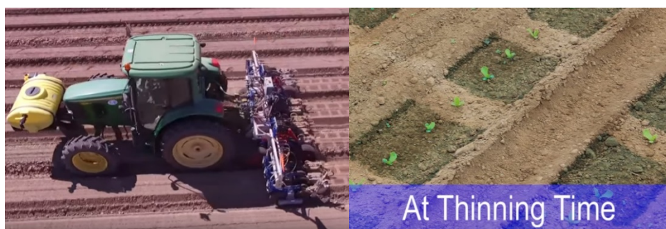
図 3 AutoThinner による作業直後の畝の様子 (黒い部分が噴霧跡)
