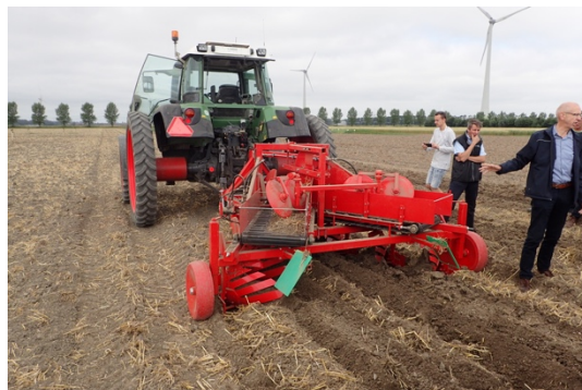
図6 CTFによる畝立て作業 (トラクタのタイヤに注目)
