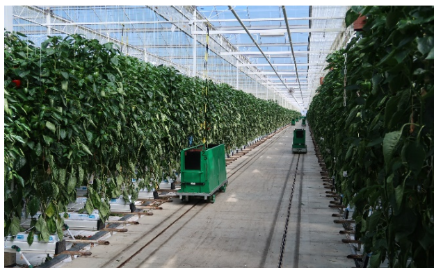
図3 多数のチェーンレール誘導式運搬車(Metazet社)が収穫物を積載して走行する様子
