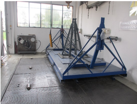
図 35 重心高さ・慣性モーメント測定装置
