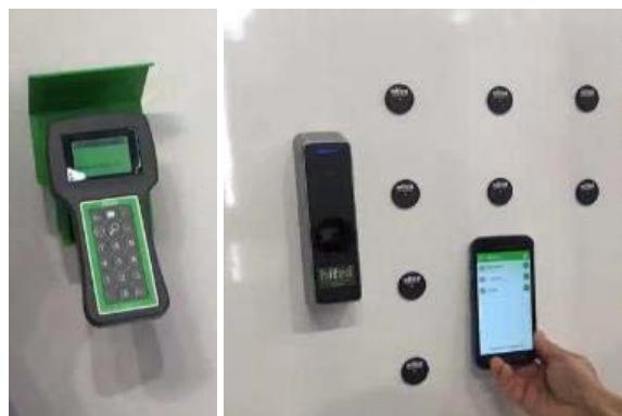
図 13 Work-IT (労務管理システム、Nitea IT Solutions 社、Hoogendoorn 社、左：労働者入力型管理端末、右：スマホ端末と NFC タグによる自動入力の様子)
