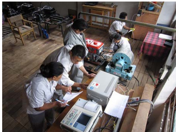
図 3 歩行型トラクタ機関性能試験
