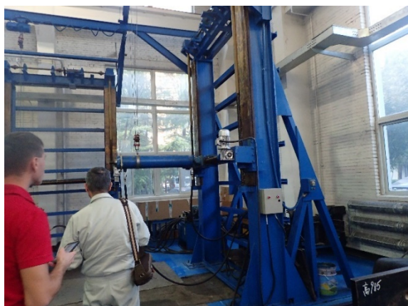
図 2 CAMTEC の ROPS 試験装置及び防水試験施設
