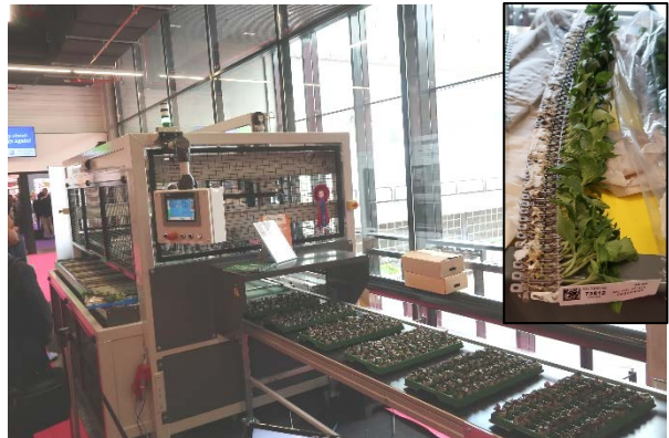
図10 Automatic Planter (挿し木ロボット、Visser社、右上: 専用ストリップ)
