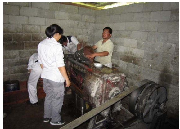
図8 搾油機作業精度試験
