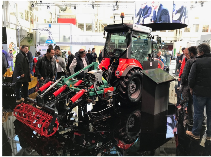
図 2 ブドウ畑用カルチベータのシリンダを駆動させるための油圧システムを TIM で制御する。必要最低限の油圧を発生させるので、燃費向上が期待できる。
