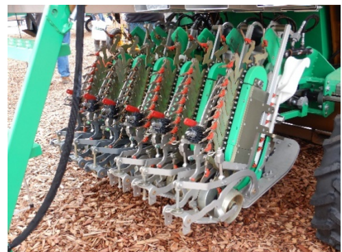
図6 PlantTape 移植モジュール 自動追従台車
