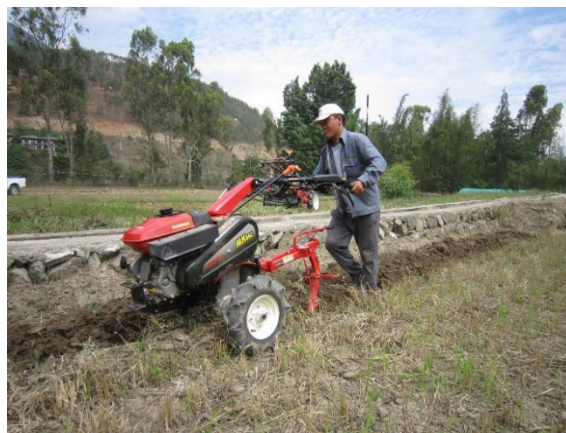
図 9 小型歩行型トラクタ作業性能試験
