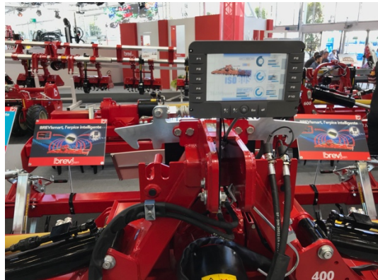
図6 COBO 社のコントローラを使用したパワーハロー
