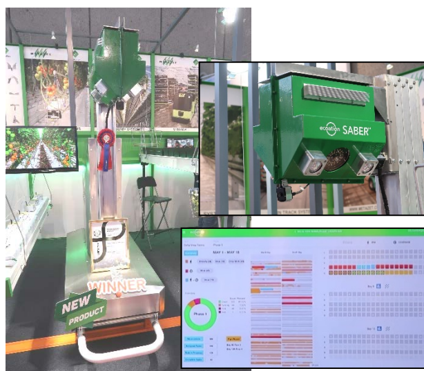
図5 SCOUT ROBOT(生体・環境計測ロボット、Micothon社、Metazet社及びEcoation社)
