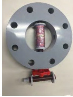
図7 管内検査用カメラ搭載ロボットの追跡用テグスを巻き取るリール（例）
