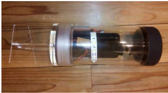
図 21 満水状態の管内部を観察する管内検査用カメラ搭載ロボットの例
