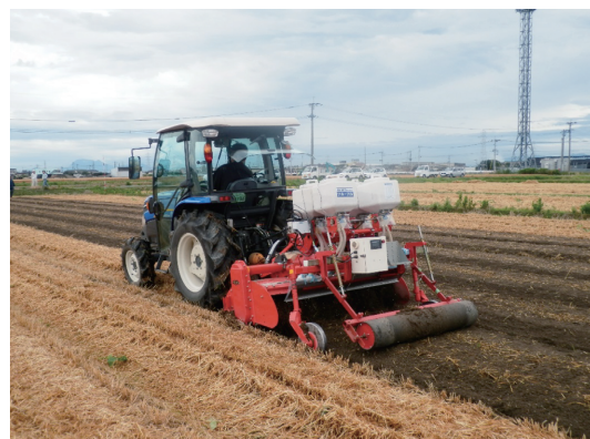
写真3 水稻「たちはるか」播種作業 表層散播機を利用して水稻「たちはるか」の種子を乾田直播している様子（2014年6月4日 みやま市で撮影）
