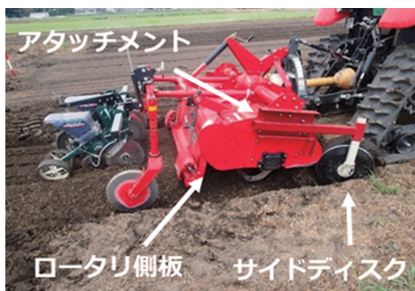
▲図1 浅耕播種機の構造
