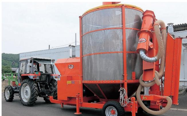
写真2 / 海外製の移動式乾燥機（AGREX社製AGD-10）
