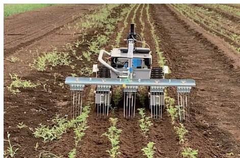
機械除草ロボット(開発中)
