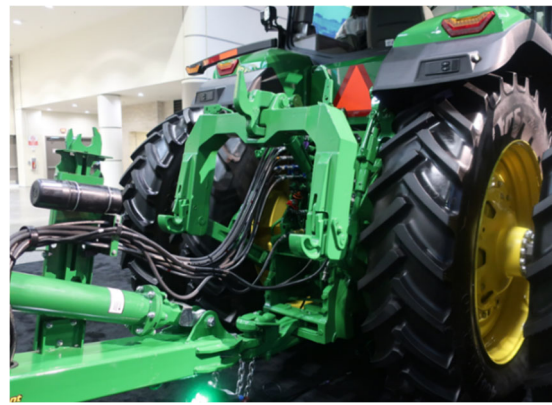
図6 ErichJaeger 化が進む ISOBUS コネクタ
