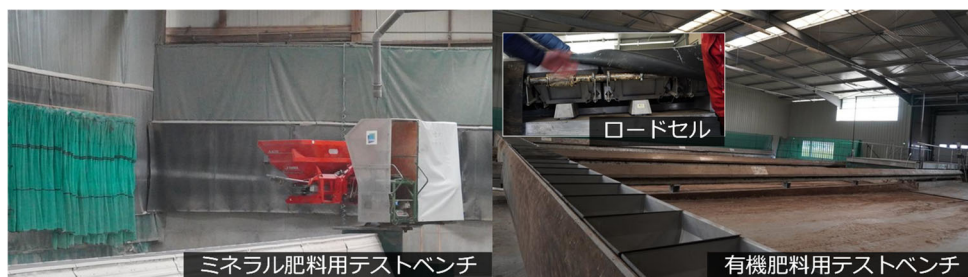
図2 肥料散布性能テストベンチ
