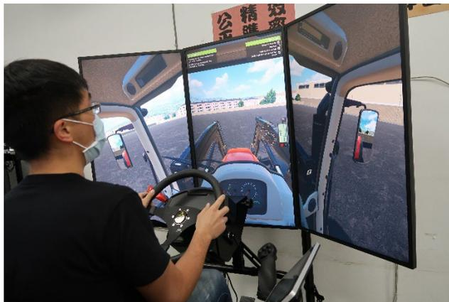
図11 乗用トラクタのライディングシミュレータ
