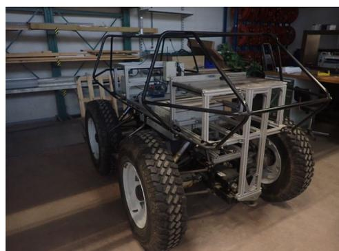
図6 INRAEが開発した農業用ロボット
