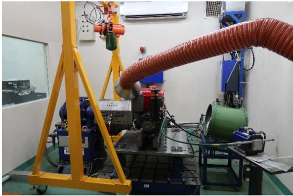
図9 小型エンジンの性能試験装置
