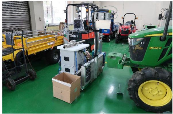
図10 可搬式の排ガス測定試験装置
