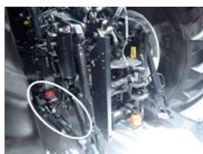
図16 作業機着脱を簡易化する油圧式
