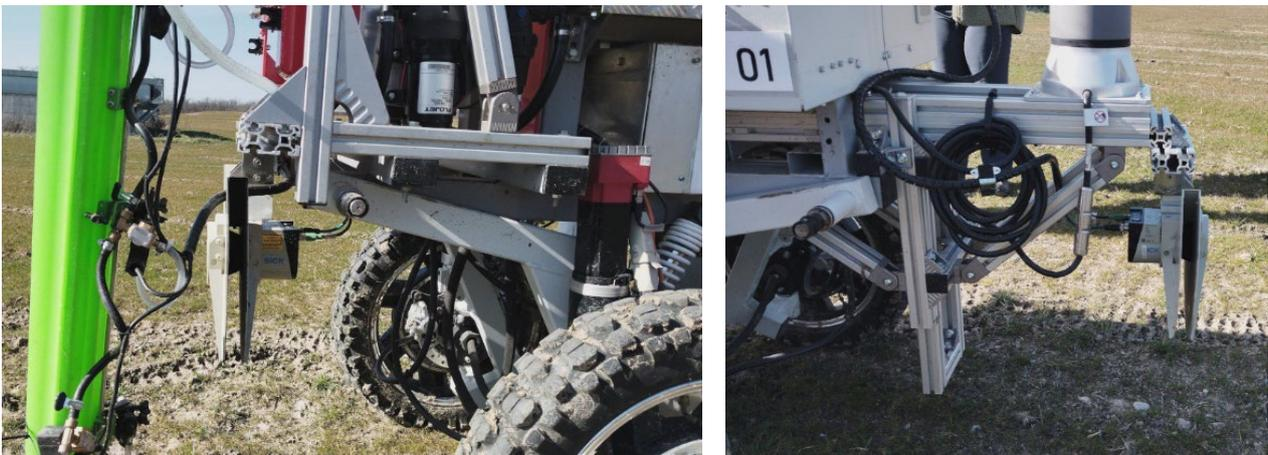
図2 ADAP2E の後方（左）および前方（右）に装着されている2D-LiDAR（LMS111, SICK）
