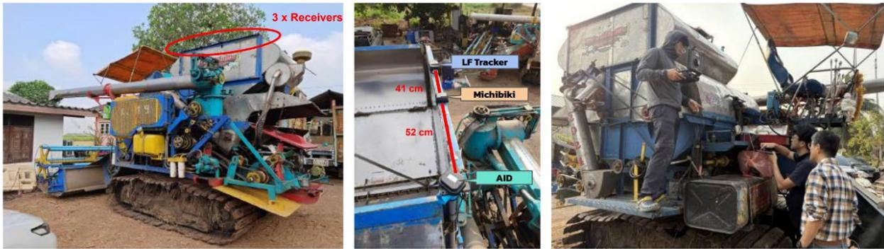
図6 タイ製農機への3種類のGNSSセンサ（GMiniR、LFトラッカー、みちびき）の設置
