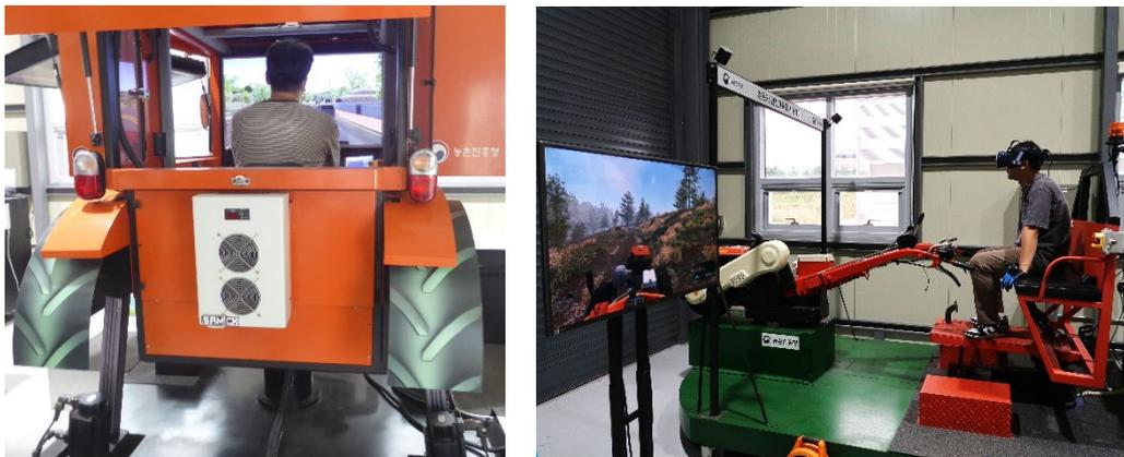
図2 ライディングシミュレータ(左:乗用型トラクタ、右:歩行型トラクタ)
