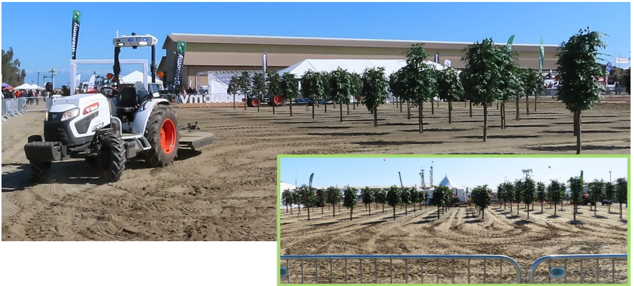
図 37 Agtonomy 社による Bobcat 製 CT4045 の自律走行する実演の様子
