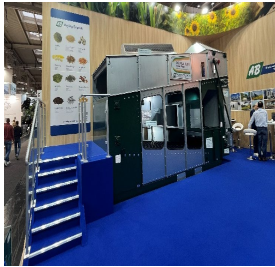
図 11 水素を熱源として利用可能な乾燥機
