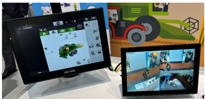
図 13 作業機 ECU の情報とカメラ画像を表示する VT
