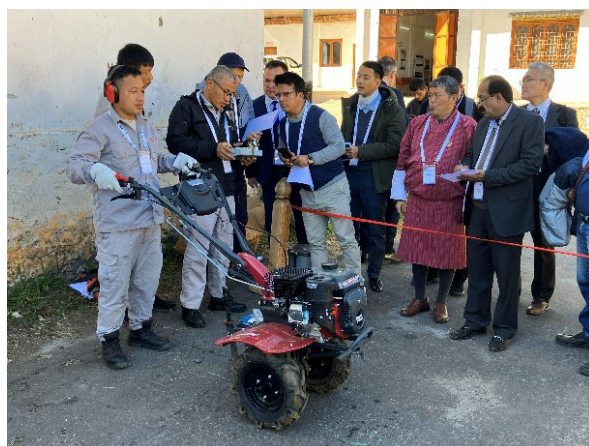
図3 ミニティラーのハンドル振動測定の実演
