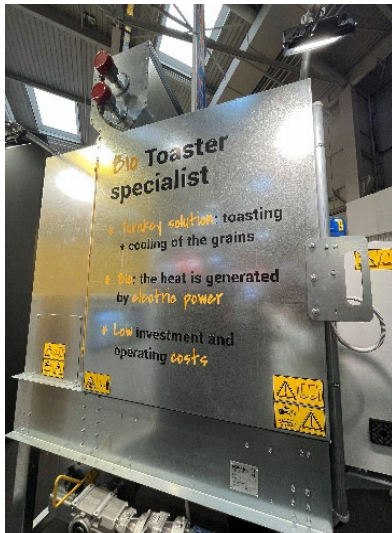
図 10 電力で温風を生成する乾燥機
