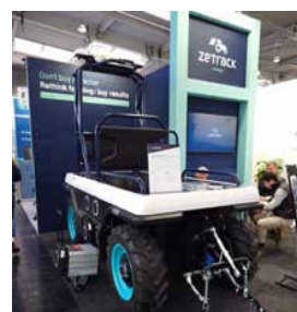
交換式バッテリーの電動トラクタ Zetrabot（ZETRACK社）
