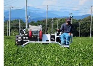
図3 試作した除草機
