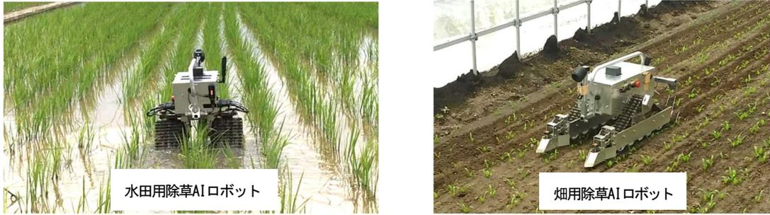
図1 2018年に試作した水田用及び畑用の除草AIロボット試作1号機
