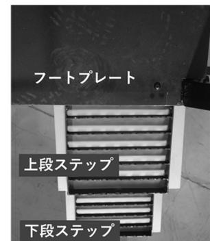
図5 一例として試作した開発機のステップ部
