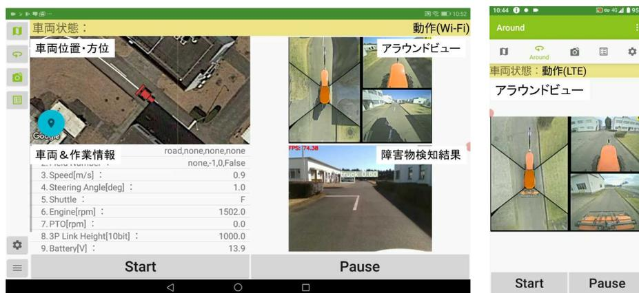
図3 遠隔監視システムのGUI (左: タブレット、右: スマートフォン)
