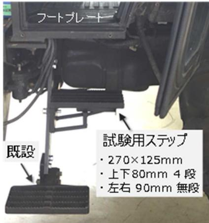
図1 試作した試験用ステップ
