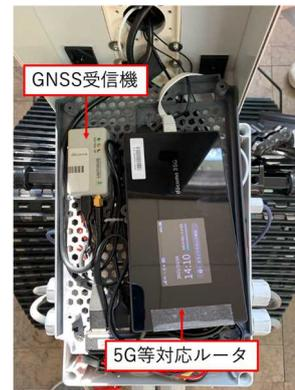
図3 高精度位置測位装置
