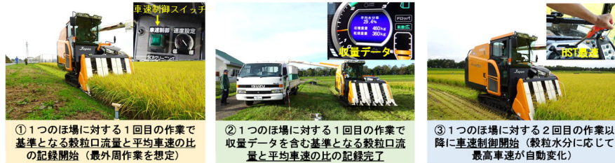
図2 車速制御を行うための操作工程(①~③)
