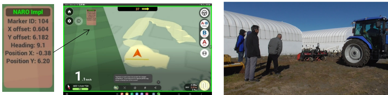
図3 マシンビジョン方式による作業機装着アシストのGUI (左)と現地実証試験の様子 (右)
