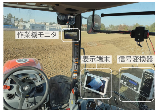
図5 トラクタに装着した均平作業ガイダンス装置
