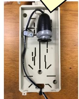
負荷側を作成します。ソケット分配器にスピーカー線やビニルキャプタイヤコードなどを接続し、ウォールボックス内に設置します。その後、充放電コントローラに接続してください。必ずテスターでプラスマイナスが逆になっていないかを確認してください。逆になった状態で、USBカーチャージャーを接続すると壊れますので注意してください。
