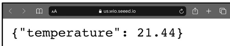
ブラウザでアクセスすることで、メーカーのサーバ (Web API サーバ) を介してデータを取得しています。この操作を自動化するためにプログラムを作成する必要があります。
