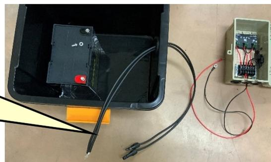
RV ボックスの中にバッテリーを置き、充放電コントローラから接続できるようケーブルを準備します。ケーブルはホームセンターで販売している 2.0SQ のスピーカー線等で問題ありません。ただし、芯径は 2.0SQ のものか、少なくとも 1.25SQ のものを使用してください。なお、充放電コントローラを設置したウォールボックスはバッテリーの隣に設置するので、スピーカー線は 50cm もあれば十分でしょう。メンテナンス性を確保する場合は RV ボックスの外から出して地面におけるように 1m 弱の長さでもかまいません。
