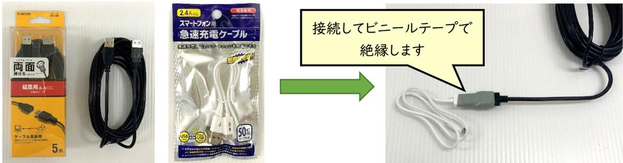
Wio Node に接続する USB ケーブル (microB) と接続してビニールテープを巻いて絶縁します。USB 延長ケーブルで延長する際は 2 個までとすることを推奨します。長くなればなるほど電圧が低下し、Wio Node が動作しません。(電圧低下は、電線の太さが細ければ細いほど、電線が長ければ長いほど起こります。そのため、細い電線を使った USB ケーブルでは延長できません。延長する際は Wio Node に接続する USB ケーブル (microB) は急速充電対応と書いてあるものを使用することを推奨します。)
