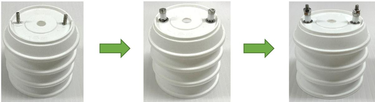
最上段の鉢皿をつけたのち、ワッシャー、スプリングワッシャー（無ければ省略可）、アイロンビーズ、ナットの順で取り付け、ナットを回して締めつけていきます。スプリングワッシャーがある場合はスプリングワッシャーがつぶれるまでしめます。無い場合は右図のようにナット2から3個分取り付けられる程度にしめます。ナットが外れるのが心配な場合は右図のようにダブルナットにしてください。
