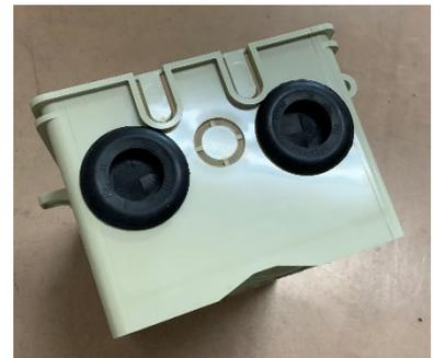
充放電コントローラを入れるケースを作ります。ウォールボックスの下部のケーブルを通せるようにします。(ケーブルブッシュがあれば使用します)
