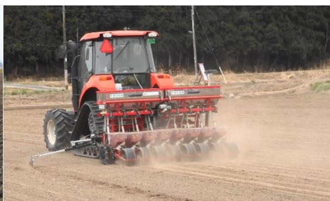
機構開発のダブルプレート式高速
