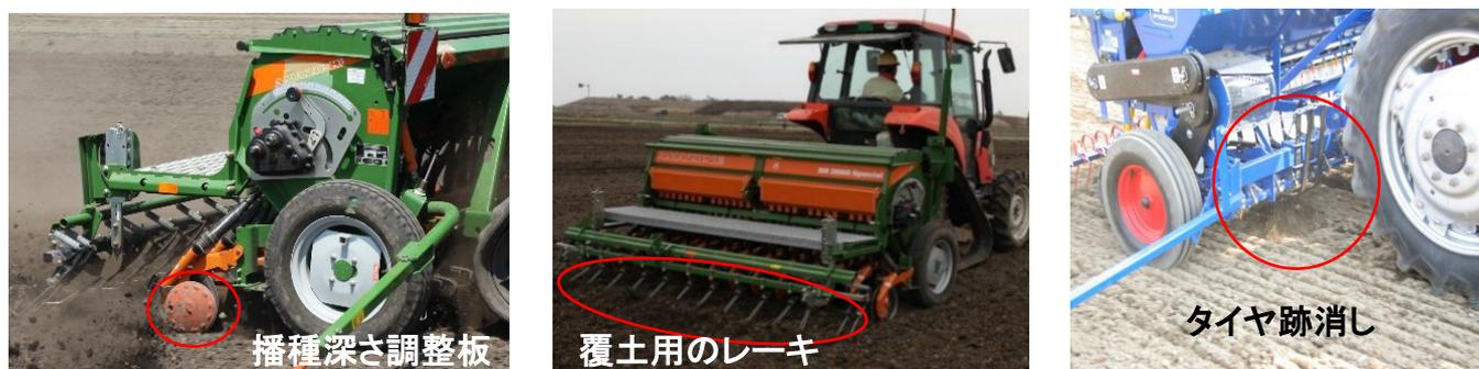
図V-6 播種作業時の調整箇所
