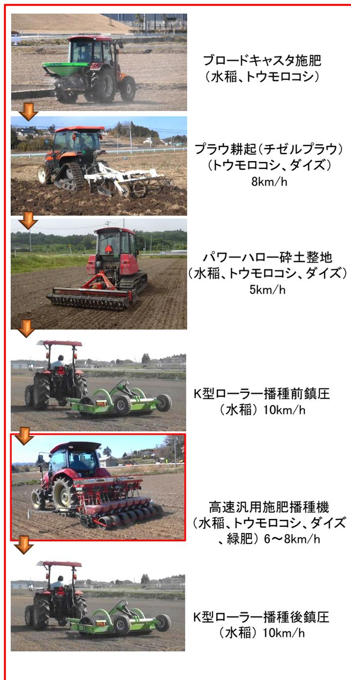
図 XV-2 プラウ耕鎮圧体系と高速汎用施肥播種機による播種作業体系
