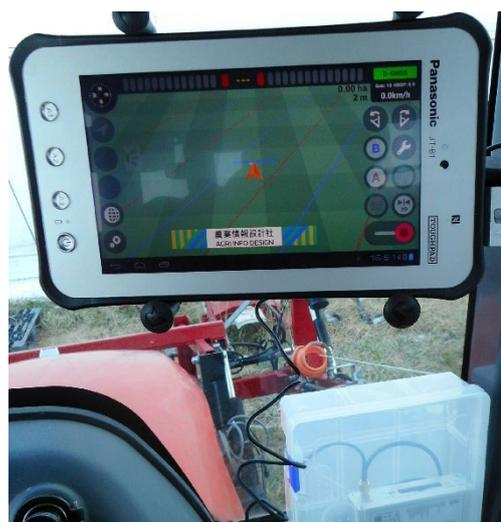
図XI-8 タブレットコンピュータと GNSS 受信機を組み合わせて構成されたガイダンス
