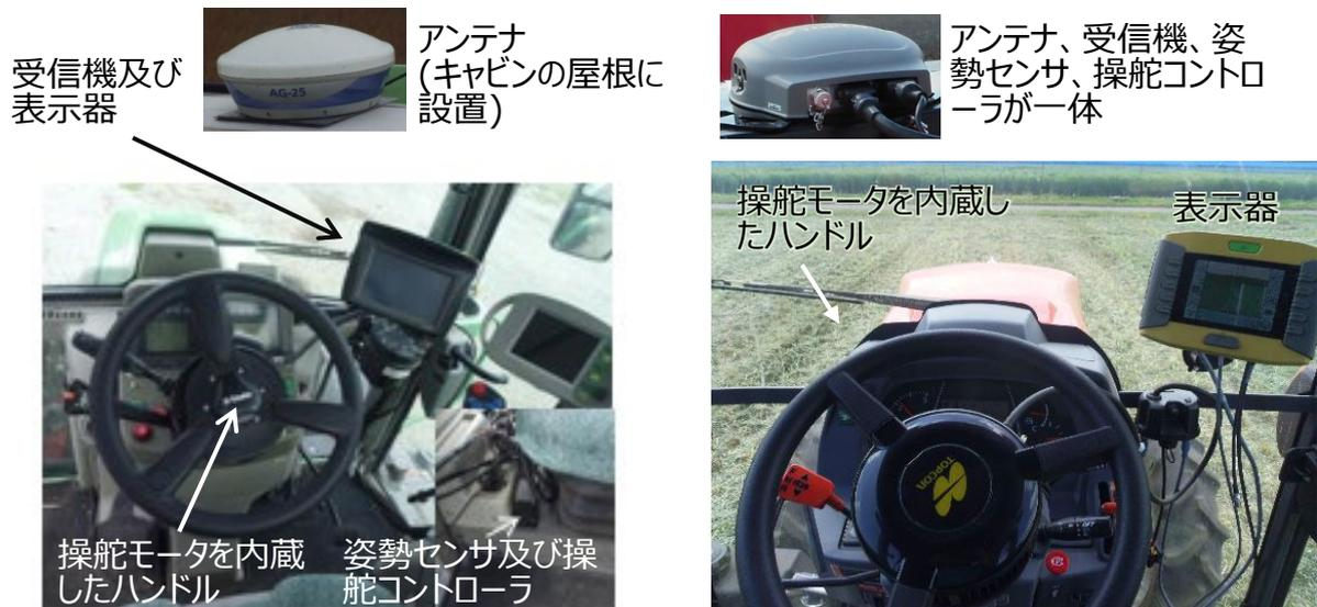
図XI-1 GNSS 自動操舵装置の例
