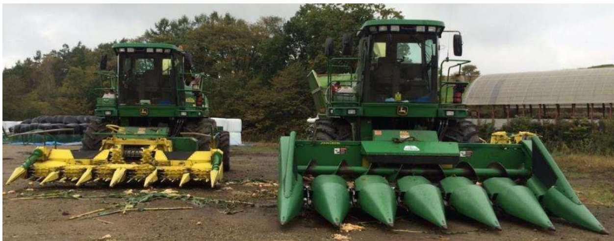
図Ⅱ-13 ホールクロープサイレージ収穫用ロータリーヘッド（左）とイアコーンサイレージ収穫用スナッパヘッド（右）を装着した自走式ハーベスタ
