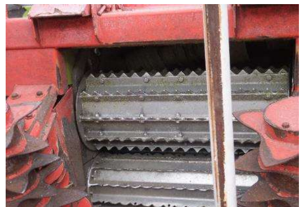
図Ⅱ-16 自走式ハーベスタに 装着されている破碎処理装置の例
