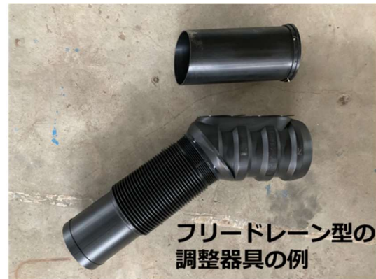
図 7 水田に設置する水位管理者の例
