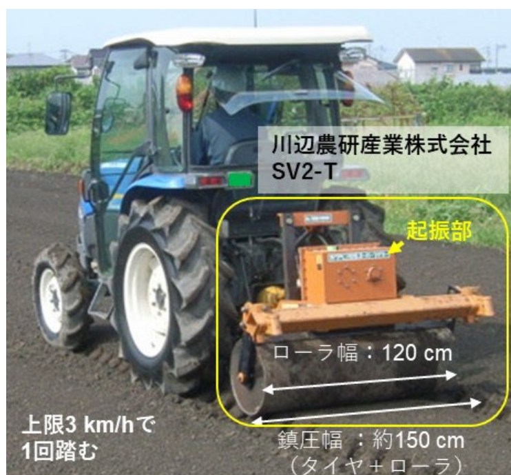
図IV-3 鎮圧工程の様子 (ローラ幅 120 cm の例)
