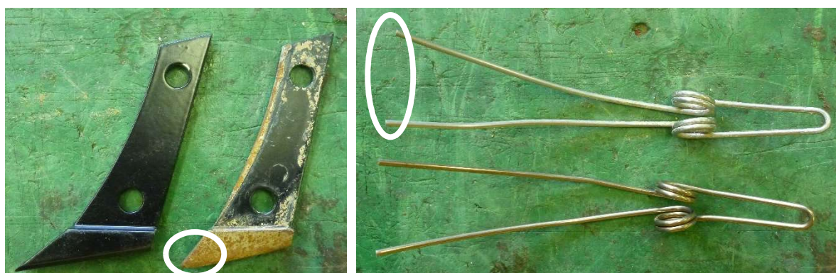
図IV-3 特に摩耗する部品（左：受刃、右：クリーナ）
