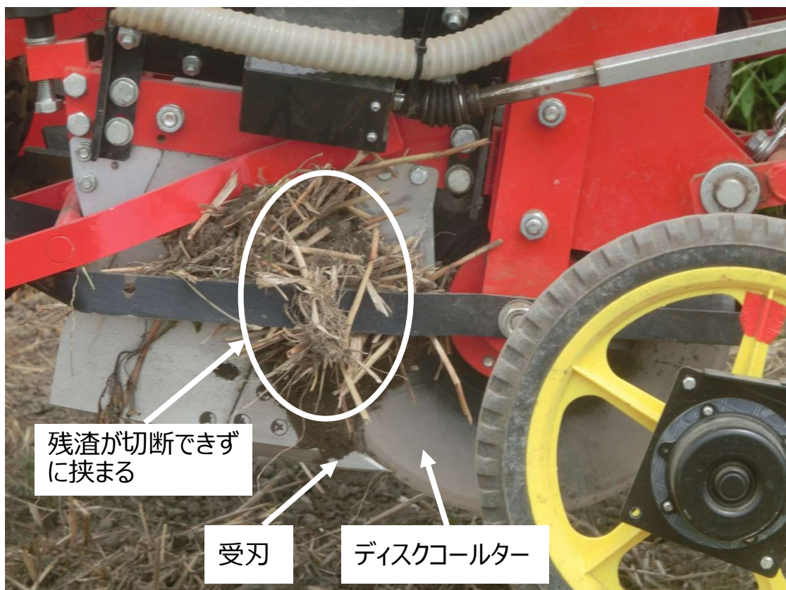
図IV-1 溝切部に残渣が挟まる例
