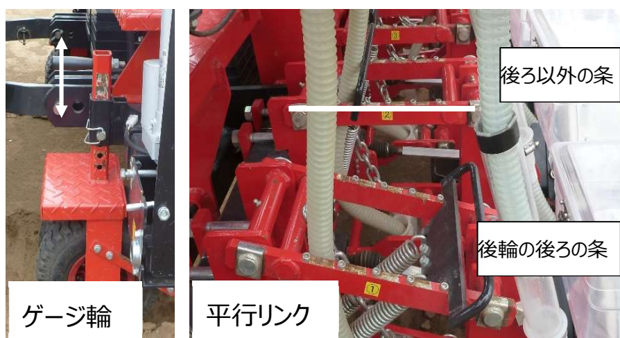
図Ⅲ-3 ゲージ輪の調整
