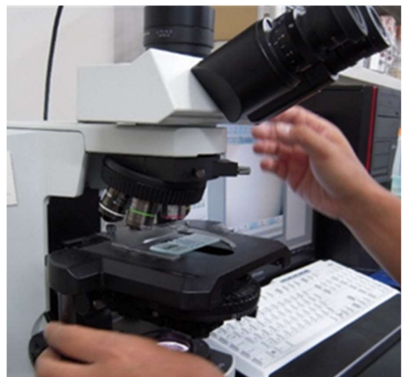
図IV-9 血球計算盤を使用し菌濃度を測定
