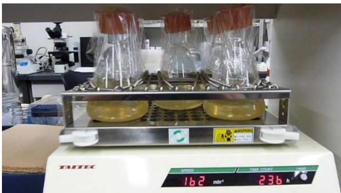
図Ⅲ-3 振とう機での培養 温度 25℃, 160rpm~, 7日~
