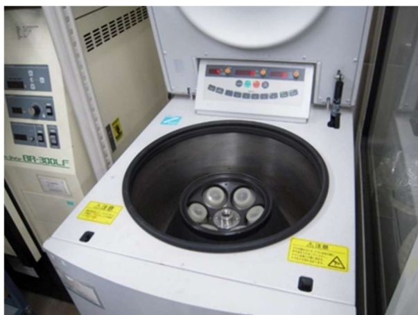
図IV-4 250mL 用固定角ローターに遠心瓶 6 個をセットした遠心分離機
