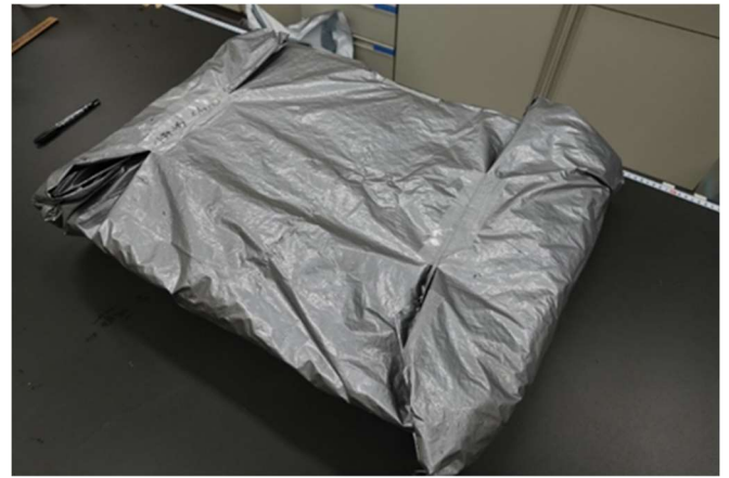
図Ⅱ-6 シルバーフィルムの端をテープ で止め 10℃の低温室に5週間入れる
