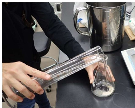
図-7 1リットルになるよう蒸留水を加えた後、適量分注する
