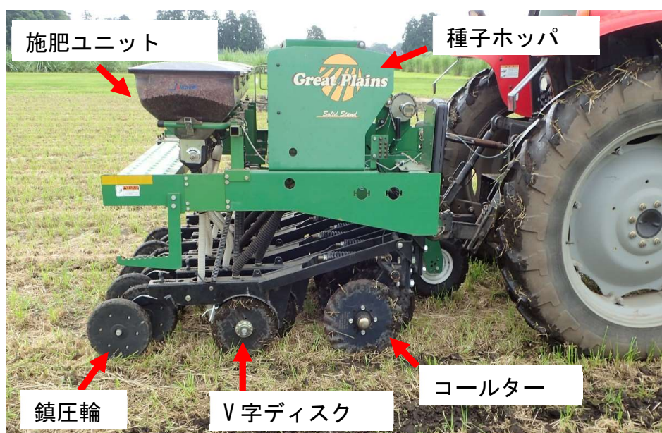
図 II - 6 技術開発に使用した不耕起播種機
