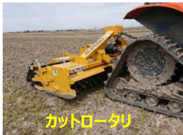
図Ⅳ-4 播種直前の基肥表層混和 時における碎土・鎮圧作業の様子
