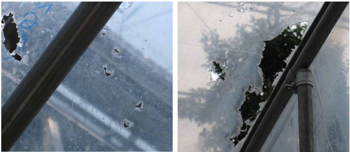
図 I -3 飼育試験でカラスに破かれたハウスフィルム（農 PO）
