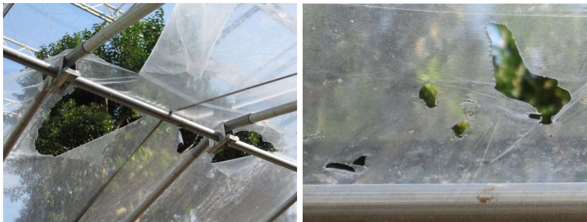
図 I -2 飼育試験でカラスに破かれたハウスフィルム（農ビ）
