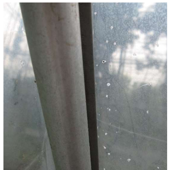
図 I -4 カラスの爪による細かい刺し傷（農 PO）
