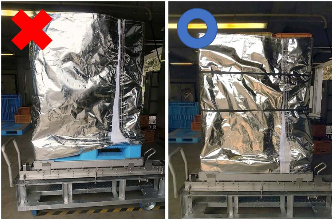
図 II-5 コンテナ側面のカバーシート装着
