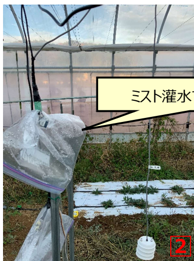
図V-3 ジッパーバッグでの防水と設置例（失敗例）
