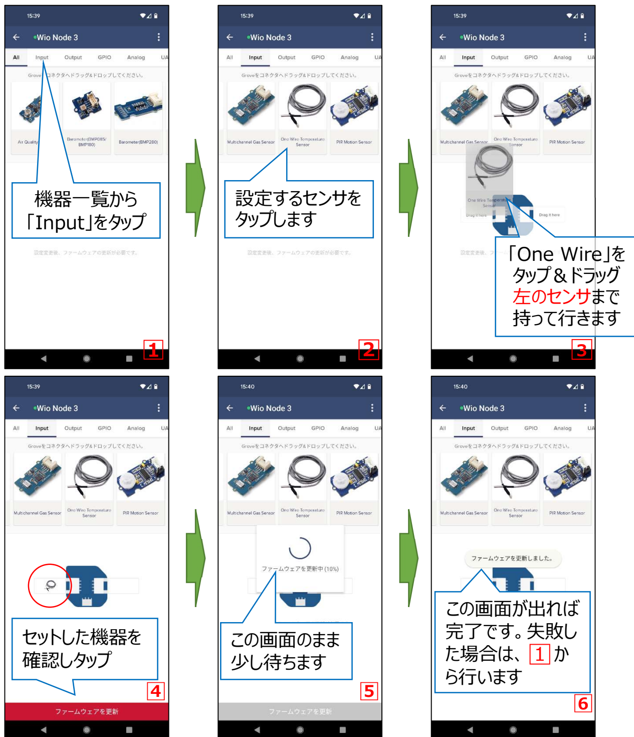
図 II -11 温度センサの設定方法
