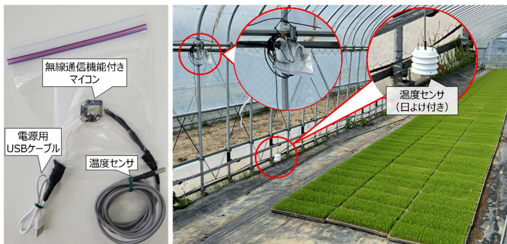
図 I - 2 現地での無線通信機能付きマイコンの設置例
