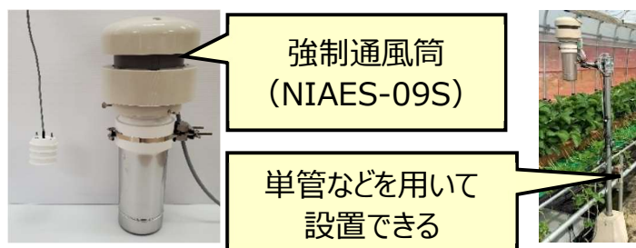
図 V-15 強制通風筒でのセンサ設置の様子
