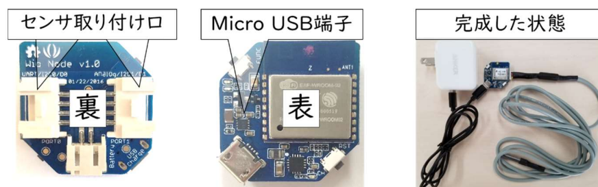
図Ⅱ-2 センサと電源用 micro USB ケーブルの接続方法
