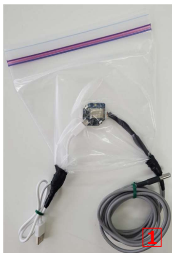
図V-3 ジッパーバッグでの防水と設置例（失敗例）
