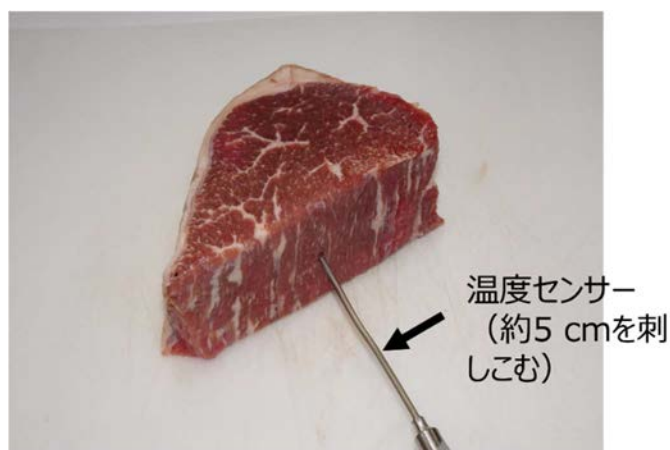
図Ⅱ-1 肉塊への温度センサーの挿入
