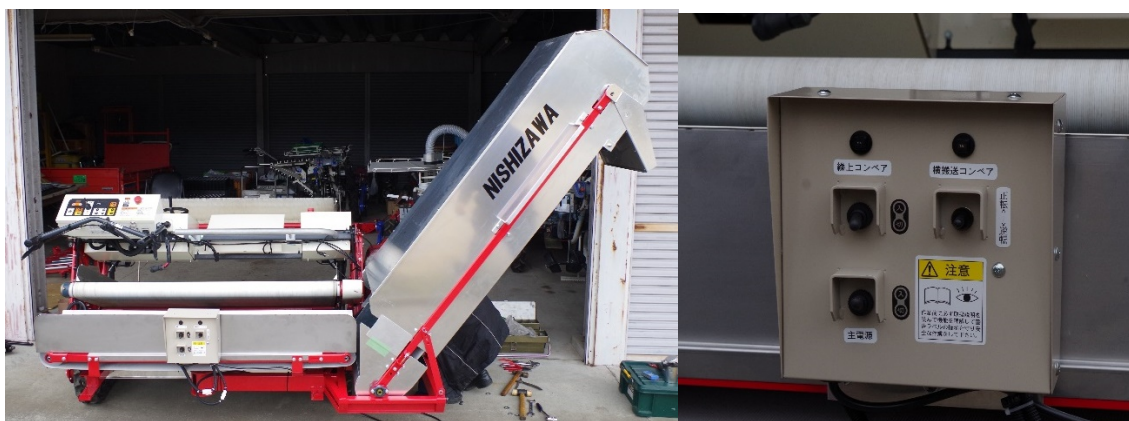
図 2-11 加工用野菜収穫機のコンベアシステム
