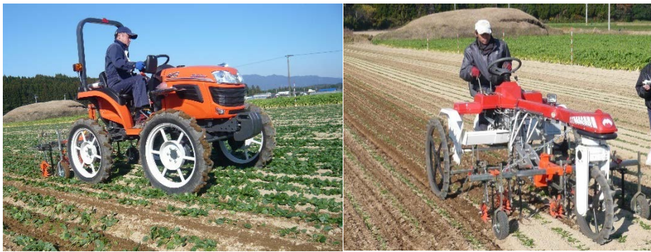
図 2-5 乗用管理機を利用した除草作業 左:4輪タイプ 右:3輪タイプ
