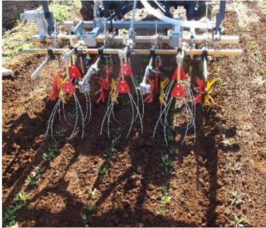
図 2-4 乗用管理機を利用したタイン型 除草機 ((株)キューハウ 狭畦栽培用除 草機 HS2-4M+TTM-4)
