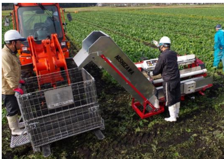
図 2-12 コンベアシステムを利用した収穫
