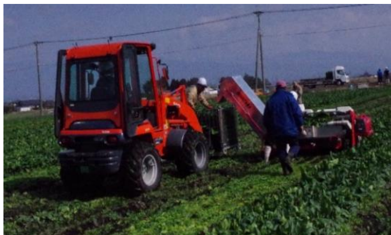
図 2-13 ホイロローダーの追従によるメッシュコンテナへの収穫
