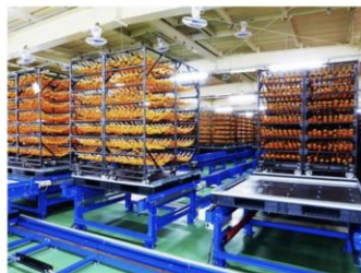
2階乾燥室、「動く干場」での自然乾燥の様子(オートメーションで連吊り台車が動き、あんぼ柿の環境差を少なくするようにしています)
