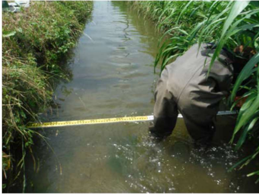
図2-18 スタッフを用いた水路幅の計測（細川晴華撮影）
