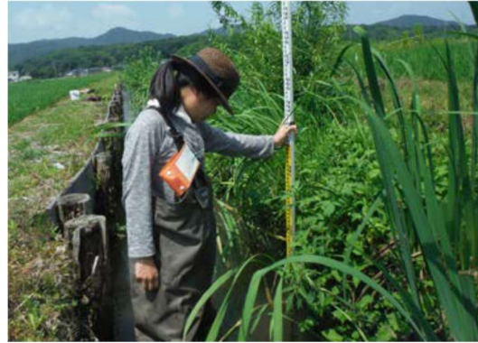
図2-19 スタッフを用いた水深計測（細川晴華撮影）
