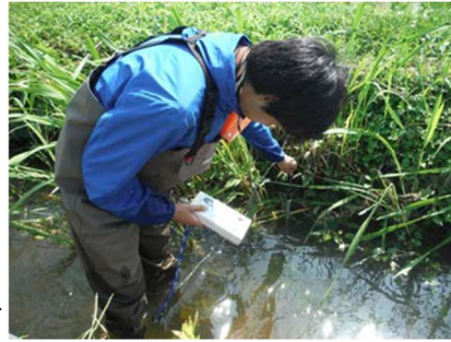
図2-22 流速計を用いた測定（細川晴華撮影）→
