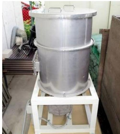
図22 リン化アルミニウム残渣取処理機
