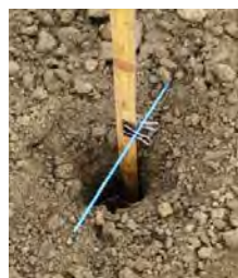
掘った穴に注水し、水位を記録する
