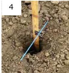
物差しを置き、棒とクリップで固定する。表層から5cm程度下まで水を注ぎ、ストップウォッチ等で計測を開始する。
