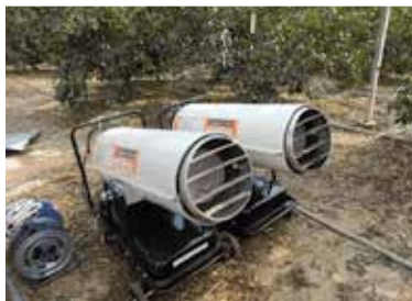
図3 油だき可搬型ヒーター・熱風式直火形（ジェットヒーター）
