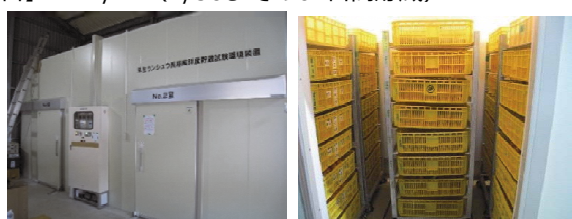
写真1 早生ウンシュウ長期高鮮度貯蔵試験環境装置と貯蔵用ラック(大青工業株式会社が開発)
